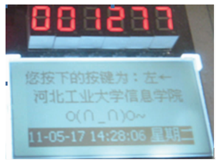
图 10 带字库硬件测试结果 Fig. 10 Hardware test result with font library
